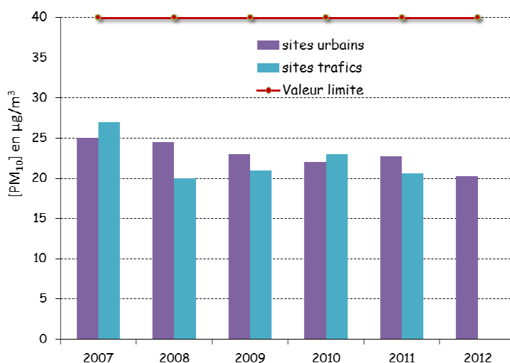
Figure 29 : Evolution des concentrations moyennes annuelles relevées en PM 10 sur les sites urbains de fond et trafic de l'agglomération orléanaise
